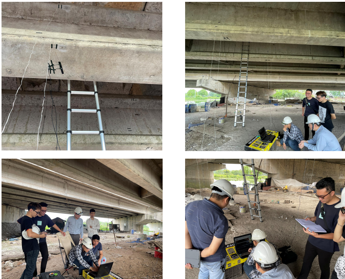
Hình 5.4. Đo dao động và biến dạng cầu Thạch Quả
